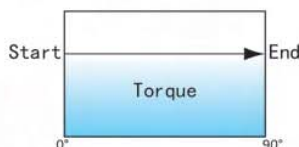
Drehmomentdiagramm doppelt wirkends stellantriebe
